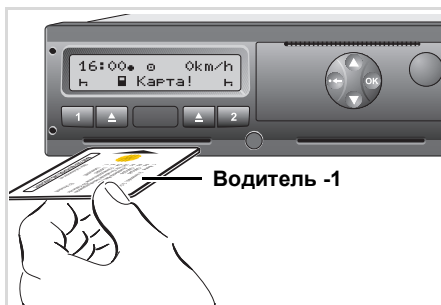
Рис. 54. Ввод карты первого водителя в тахограф
